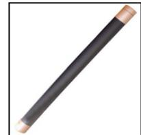
In assenza di sufficiente autosostentamento delle pareti del foro ad ogni manovra di carotaggio è seguita una manovra di rivestimento utilizzando tubi di diametro 127 / 140 mm, dotati di una scarpa ad inserti di widia. Le operazioni di rivestimento,
