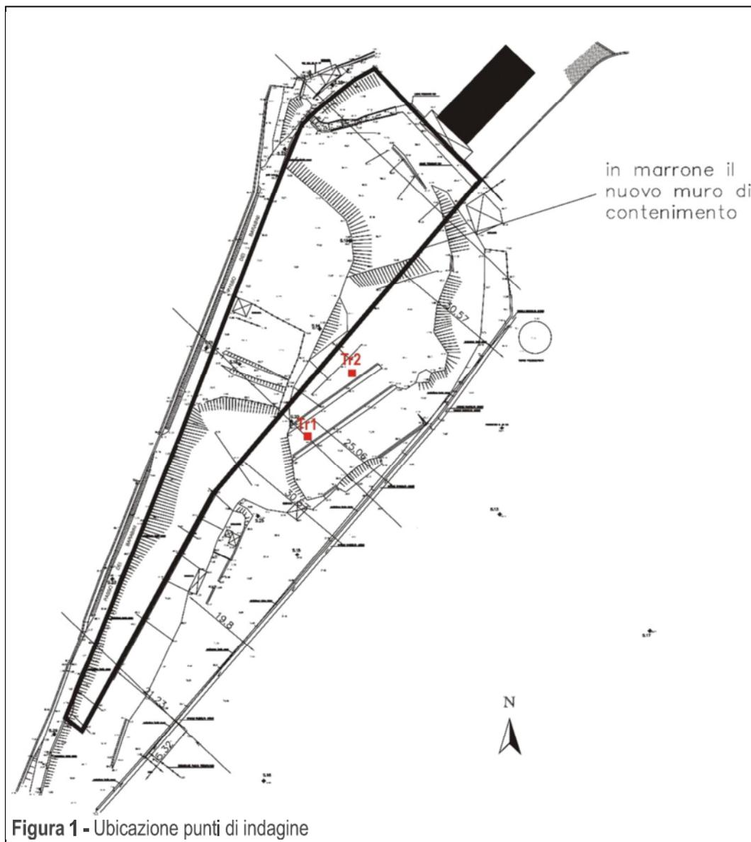
L'utilizzo di questa tecnica geofisica consente di ottenere tutta una serie di informazioni, in particolare sulle frequenze di risonanza dei terreni di sottosuolo, utili per verificare l'interazione dal punto di vista sismico del sistema terreno-strutture.
