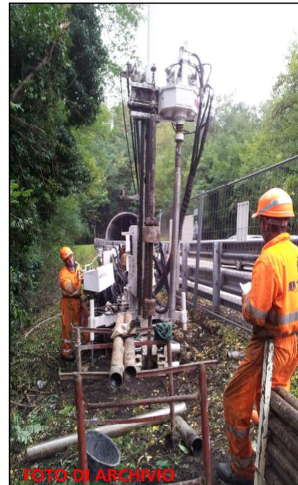
“avviamento”, s'intende superare la zona di terreno rimaneggiata in fase di perforazione; se con  $N_1 = 50$  colpi l'avviamento è minore di 15 cm., l'infissione deve essere sospesa e la prova si dichiara conclusa, annotando la relativa penetrazione.
